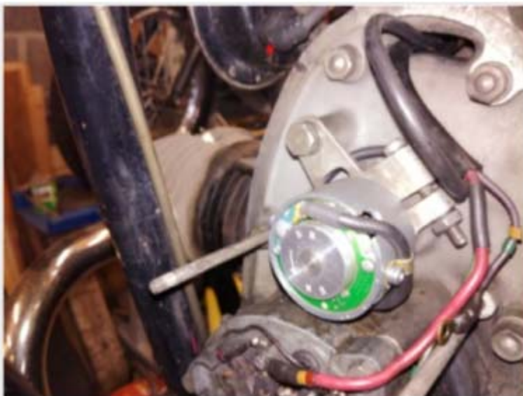
Montage du capteur de l'allumage dans le carter de la C6S
