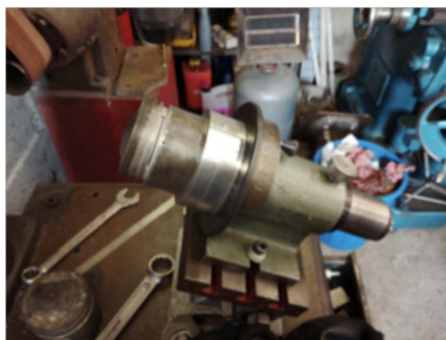
Reprise du piston au diviseur pour le perçage de 7 trous de 3mm à 30°
