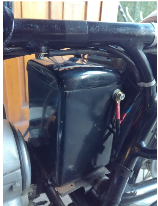
Montage de deux batteries 6Volts (en parallèle) ou en 12 volts (série) pour C6S
