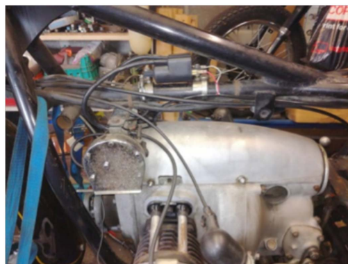
Autre montage de la bobine double allumage dans le cadre
