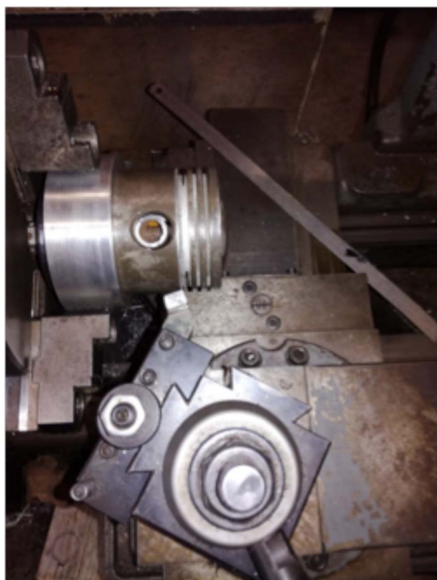
Reprise au tour, afin d'exécuter un chanfrein sous le segment racleur (angle 30°, profondeur 0.6mm)
