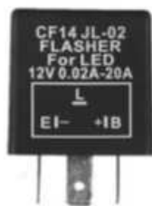
Exemple de centrale de clignotants universelle en 12V (intensité de 20mA à 20A) Le modèle CF14 n'est pas impératif
