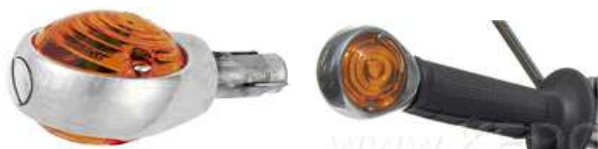
Clignotant de marque Hella des années 60 (il existe des équivalents modernes)
