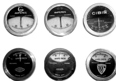
L'ampèremètre se câble en série dans le circuit « batterie », le fil + de la batterie. Ces ampèremètres ont une position de repos
