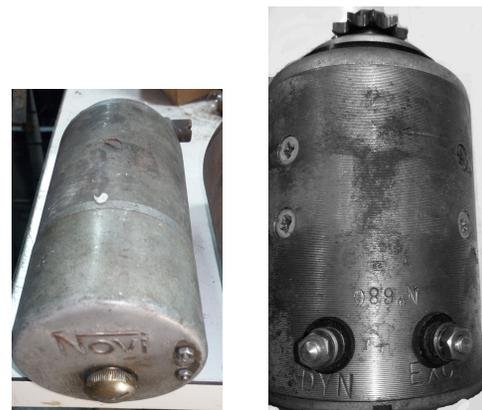
Il est préférable de monter la Magnéto-France sur nos L7 car elle est plus puissante que la Novi. Par ailleurs une dynamo à régulation magnétique doit toujours être chargée par la batterie et un fusible de protection est inclus dedans. La dynamo Novi est jolie mais techniquement dépassée.
